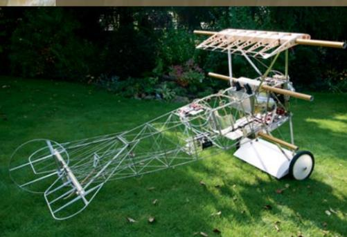
Der fertige Rohbau, einmal mit und einmal ohne montierte Flächen, die aus Transportgründen dreiteilig aufgebaut sind und unbespannt, aber inklusive der Steckrohre 17,4 kg wiegen.
