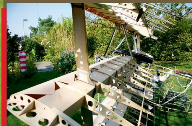
◀ Auf den Bildern links wird der Aufbau der Tragfläche deutlich: Erleichterungsbohrungen, verstärkende senkrechte Sperrholzstreifen, aufgeklebte Fichtengurte, Doppelrippen und die Verklebung von Rippen und Holm mittels Dreikantleisten sind gut zu erkennen.
