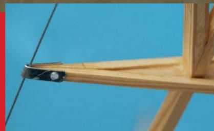
Über den an den Rippenenden verlaufenden Spanndraht wird die Flächenbespannung gezogen.
