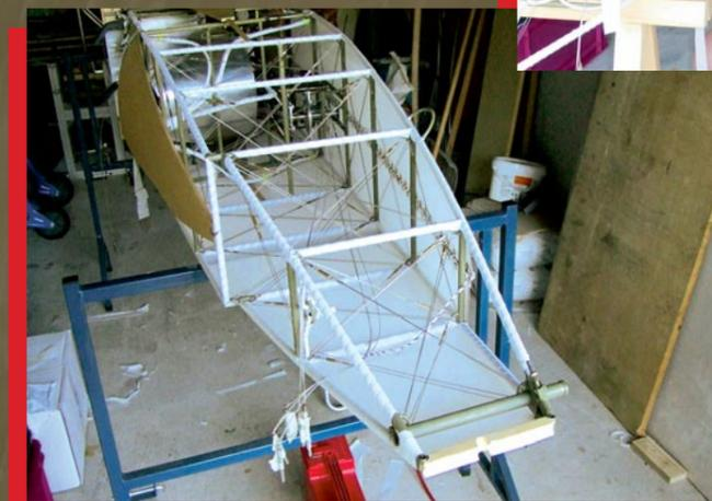
Manfred Schnepf beim Umwickeln der Stahlrohre mit Gewebekleber. An diesem wird die Bespannung nach dem Verkleben vernäht.
